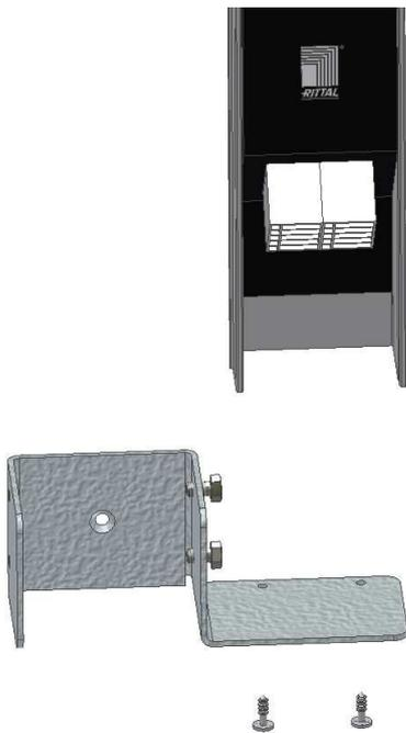
Abb. 6 Befestigung des Bügels
