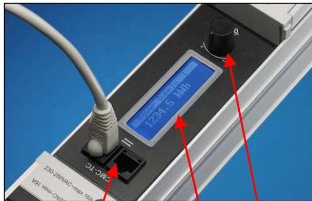
**I/O Port: Anschluss an CMC-TC bzw. Netzteil**
