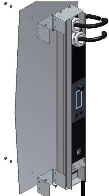
Abb. 8 Befestigung an Montageplatte
